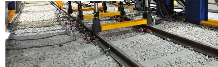
Conjunto de sensores internos en una de las secciones del Cajón (47 en cada Zona)
