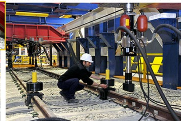
Actuadores piezoeléctricos de alta frecuencia para la simulación del efecto de las imperfecciones de la vía en las cargas dinámicas
